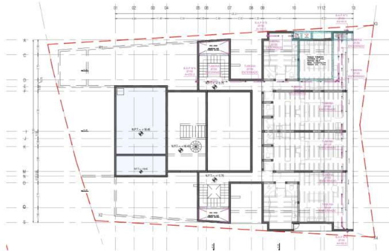
Figura 18. Plano instalación pluvial.
