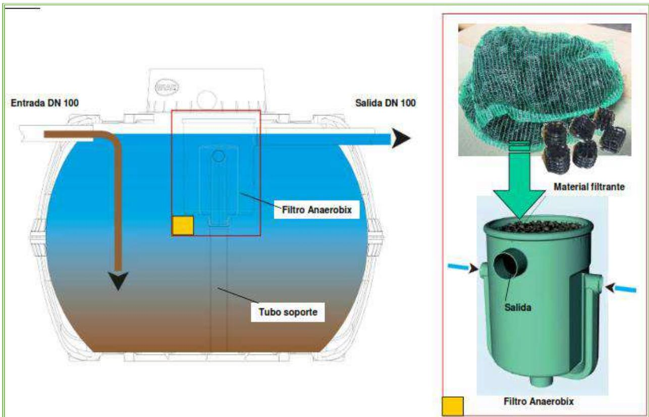
Ilustración II.2 Funcionamiento del biodigestor
