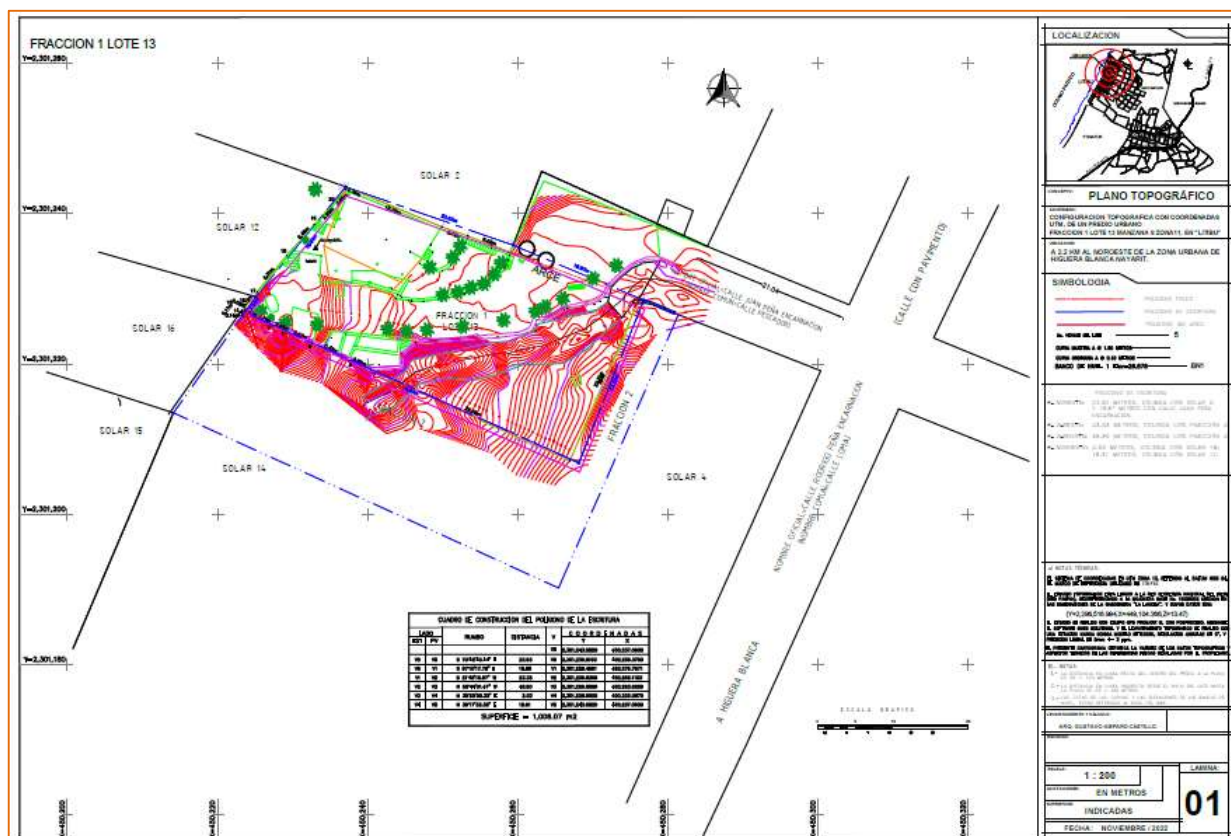
Ilustración II.4. Plano topográfico con coordenadas UTM.
