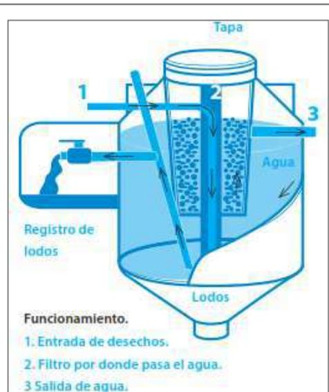
**Imagen II4** Funcionamiento del Biodigestor Autolimpiable
