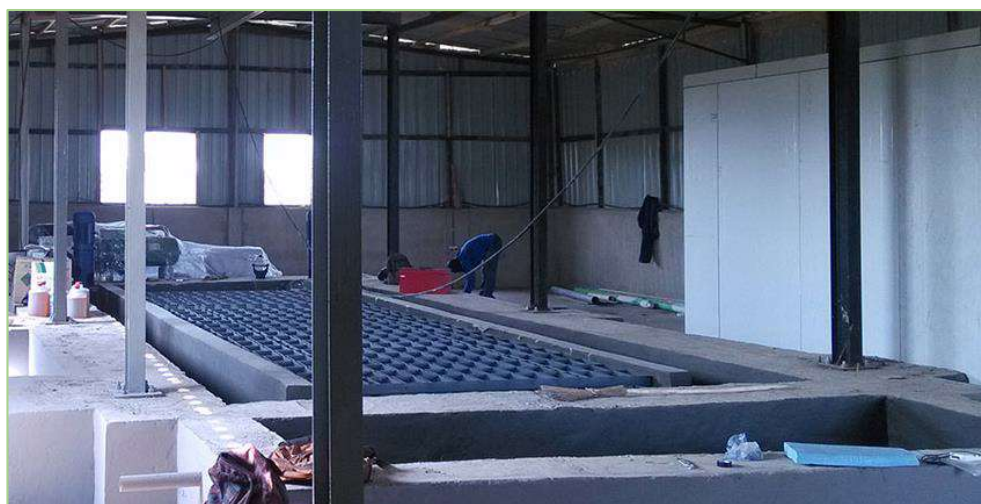
Imagen II.4 Ejemplo de estanque de congelamiento con salmuera para la fabricación de barras de hielo.
