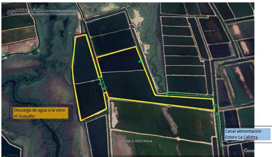
Sitio del proyecto, indicando con flechas en color rojo la ubicación de las compuertas de descarga, en color verde se indican las compuertas de alimentación, se indica el curso del canal de alimentación de agua que se aprovechará para el cultivo.
