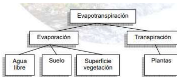
FIGURA. IV.16 La evapotranspiración está dividida en dos subprocesos: evaporación y transpiración.
