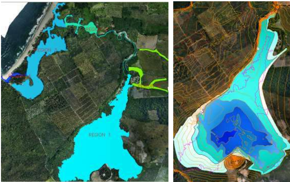
FIGURA IV.40. Esquema de la regionalización hidrodinámica de la Laguna la "El Colomito" para la descripción de sus patrones de circulación y dispersión y zonas de la Laguna de acuerdo a su profundidad.
