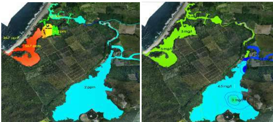
Tipos de salinidad en la laguna El Colomito y estero Canalan y Concentración de oxígeno disuelto en los mismos cuerpos de agua en mg/l
