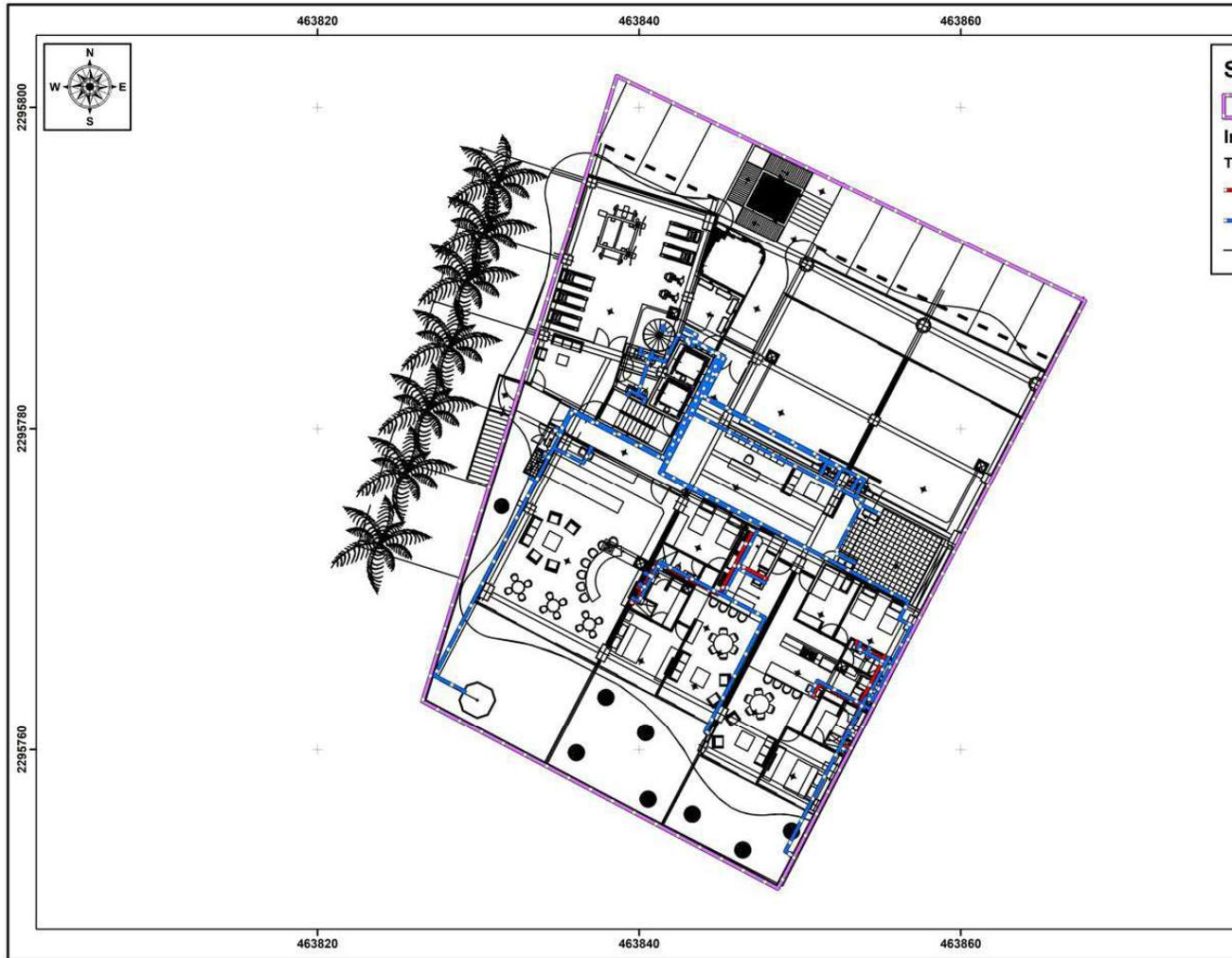
Plano II.5. Instalación hidráulica planta baja
