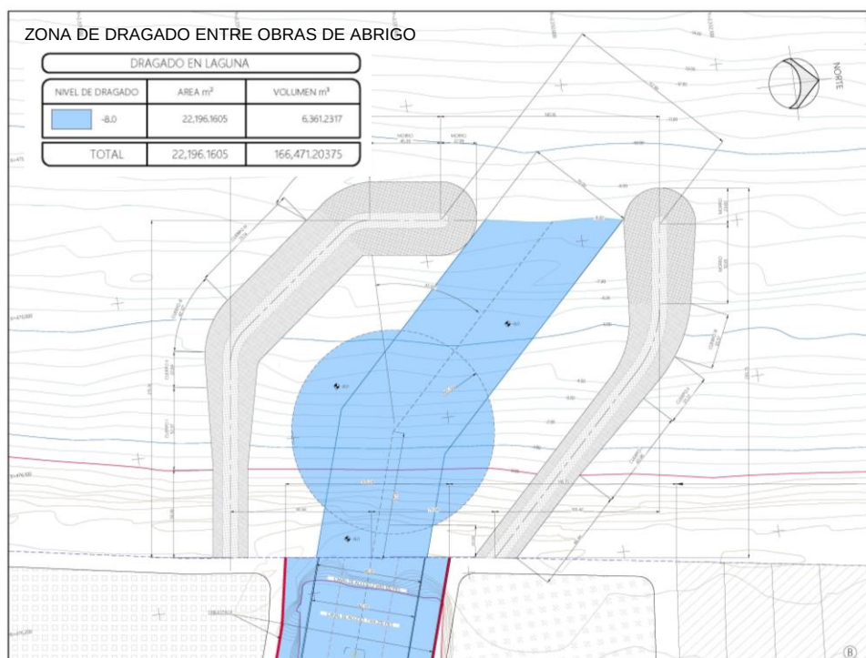
Zona de Dragado entre las obras de abrigo antes de la Marina.
