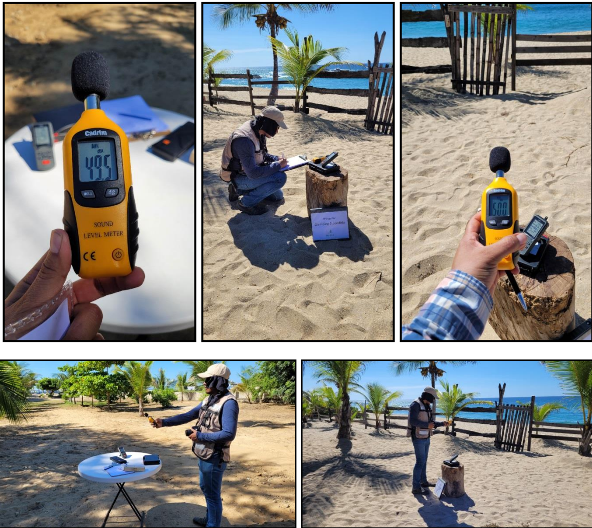
Imagen 54 Medición de los niveles de ruido en el área del proyecto y colindancia con la playa
