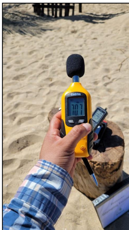
Imagen 53 Equipo empleado para la medición del ruido, se observan los niveles máximos y mínimos registrados
