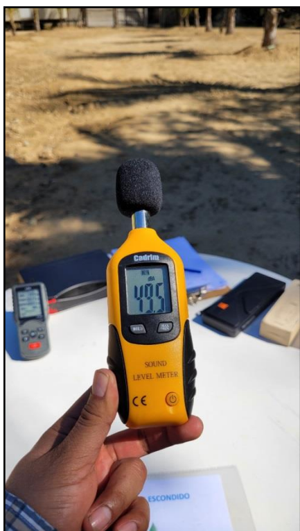
Imagen 53 Equipo empleado para la medición del ruido, se observan los niveles máximos y mínimos registrados
