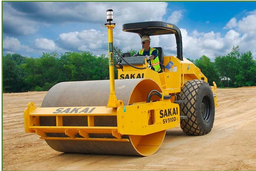
Ilustración II-22 Compactador vibratorio de rodillo liso.
