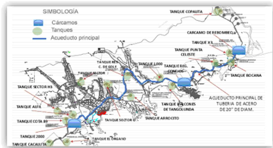
Figura II.3. Sistema de agua potable en la zona del proyecto (Fuente: FONATUR, 2018).
