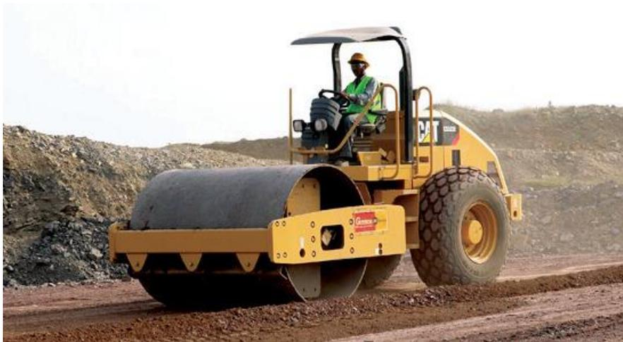
**Figura II.16.** Ejemplo de un rodillo compactador a utilizar en la ejecución del proyecto.
