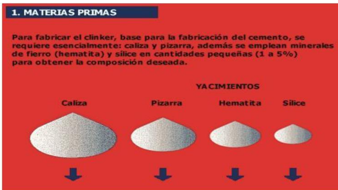
Figura II.4. Se pueden observar las diversas materias primas que se requieren para la fabricación del cemento, observándose que la “hematita” es una de las materias primas principales. Fuente: Página de internet: https://ingivanfuentesm2.es.tl/CEMENTO.htm .
