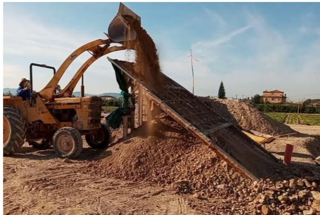
Figura 11.-Imagen ilustrativa del cribador y separación del material.
