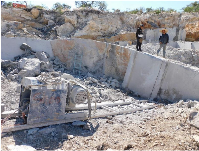
Figura 8. Equipo utilizado para aplicar el corte con hilo diamantado.
