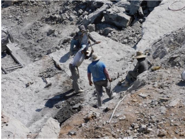
Figura 7. Perforación neumática y colocación de cuñas guiadas.
