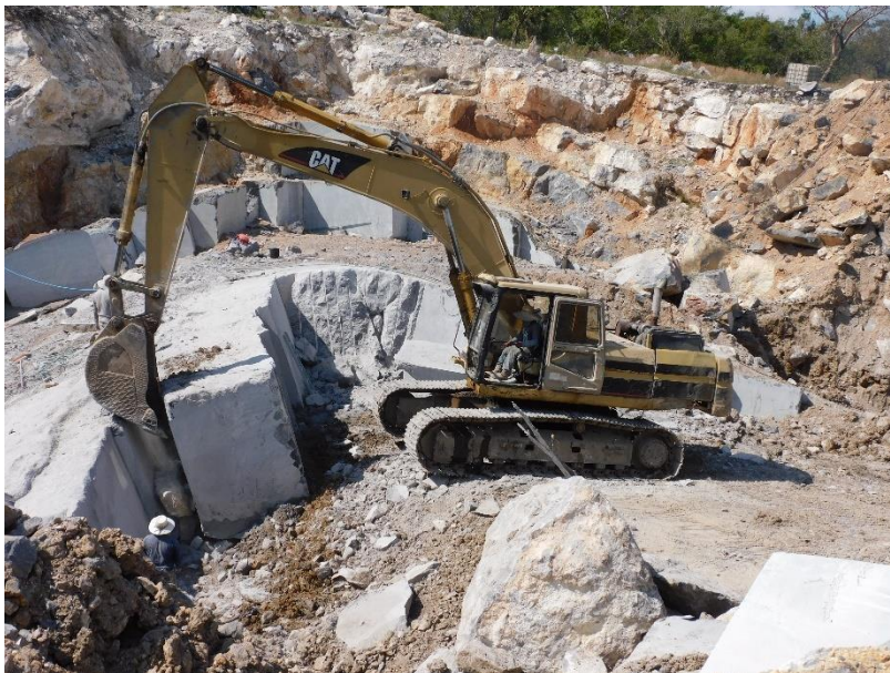
Figura 9. Separación de bloques con ayuda de una retroexcavadora.
