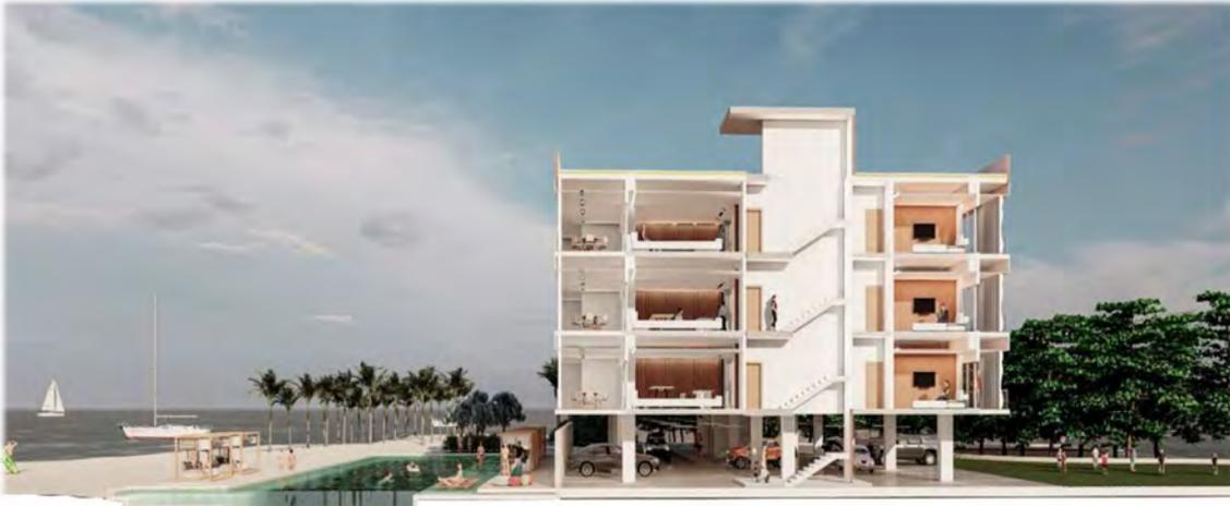
Plano que muestra la sección arquitectónica del Edificio D, del conjunto condominal Nachi Cocom.
