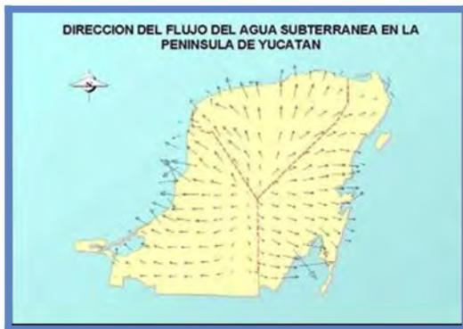
**Imagen 26.** Circulación natural del agua. Fuente: CNA
