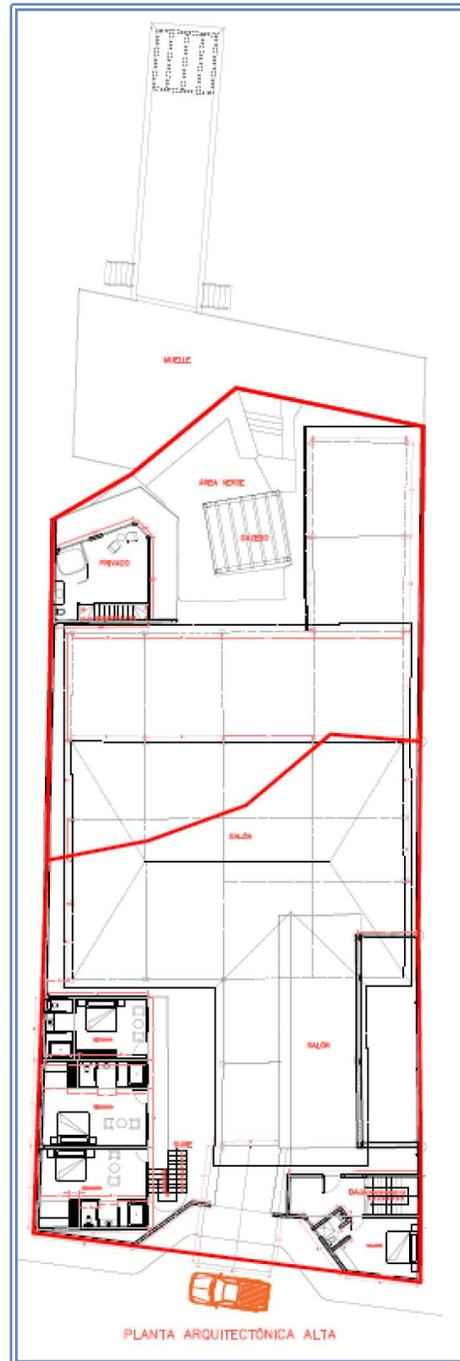
En P.A. el proyecto cuenta únicamente con 3 habitaciones simples en la porción NW, un privado con 1 habitación en el frente marino y bodega en el extremo SW. Alcanza una altura de 6.35 ml hasta el remate de los edificios y, 11.00 ml hasta el vértice de la palapa de 4 aguas.
