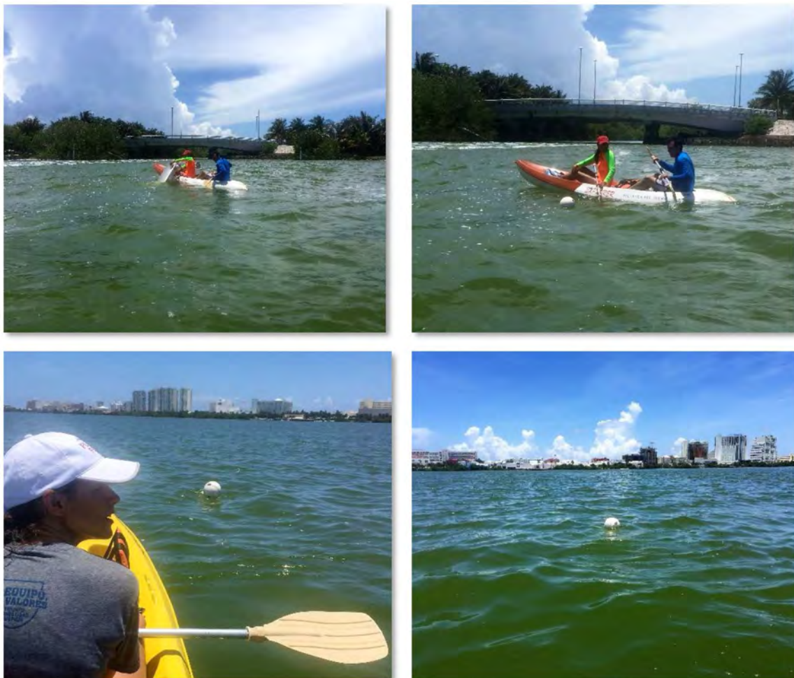
Figura IV:17. Liberación de crucetas de deriva para la medición de corrientes superficiales en la Laguna Bojórquez. Trabajo de campo realizado en el mes de julio.
