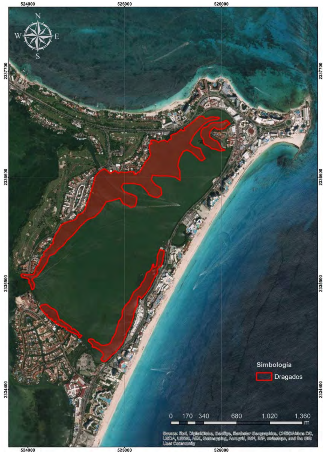
Figura IV:52. Dragados realizados en la Laguna Bojórquez para el establecimiento y desarrollo de la Zona Hotelera. Elaborado con base en el estudio “Laguna Bojórquez, Cancún: un sistema de características marinas controlado por la atmósfera” y mediante percepción remota con base en imágenes satelitales.
