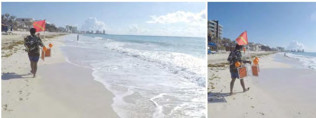
**Figura 25.** Derivador utilizado para el estudio de las corrientes marinas.
