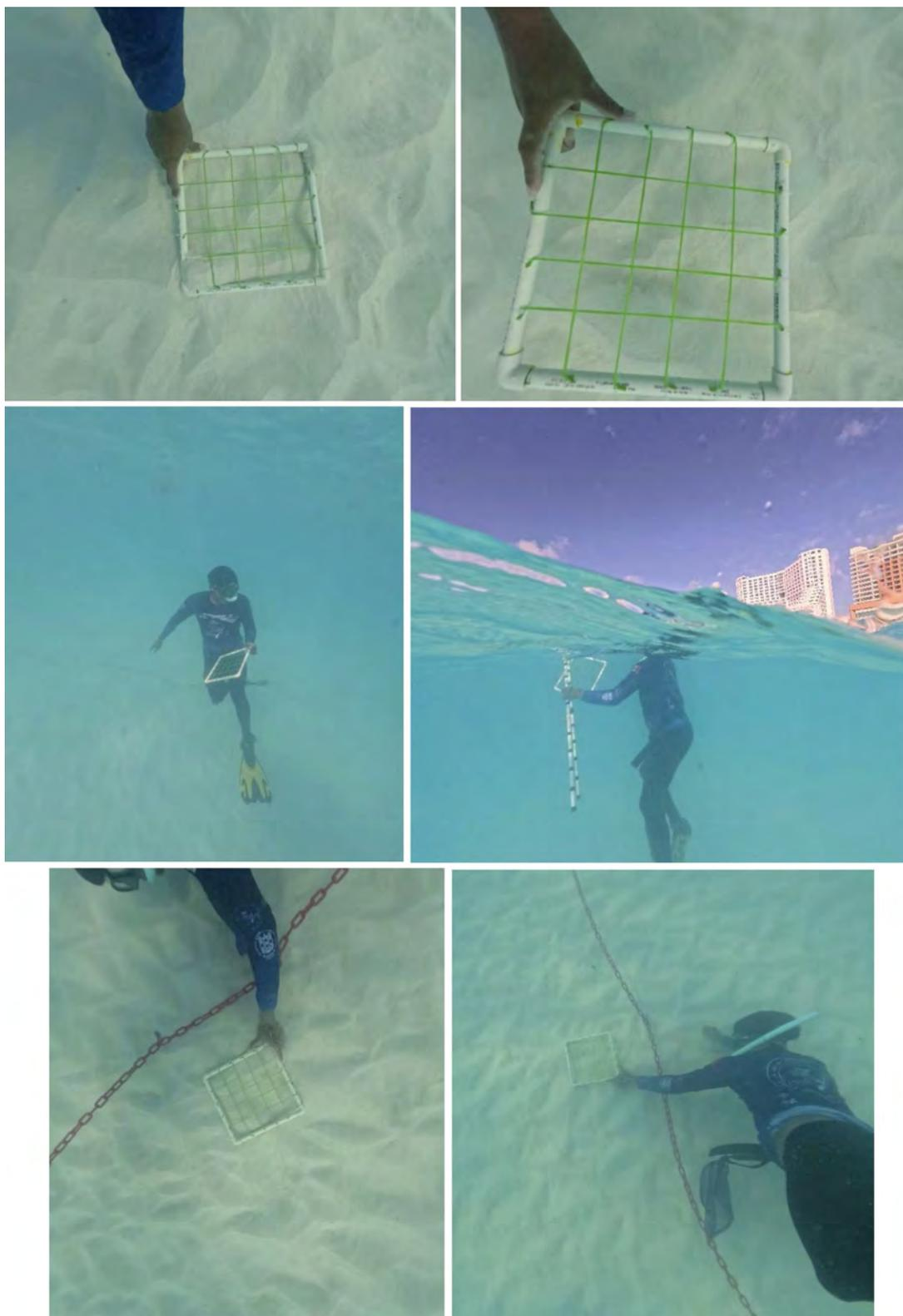
Figura 14. Instalación del marco de muestreo en cada estación.
