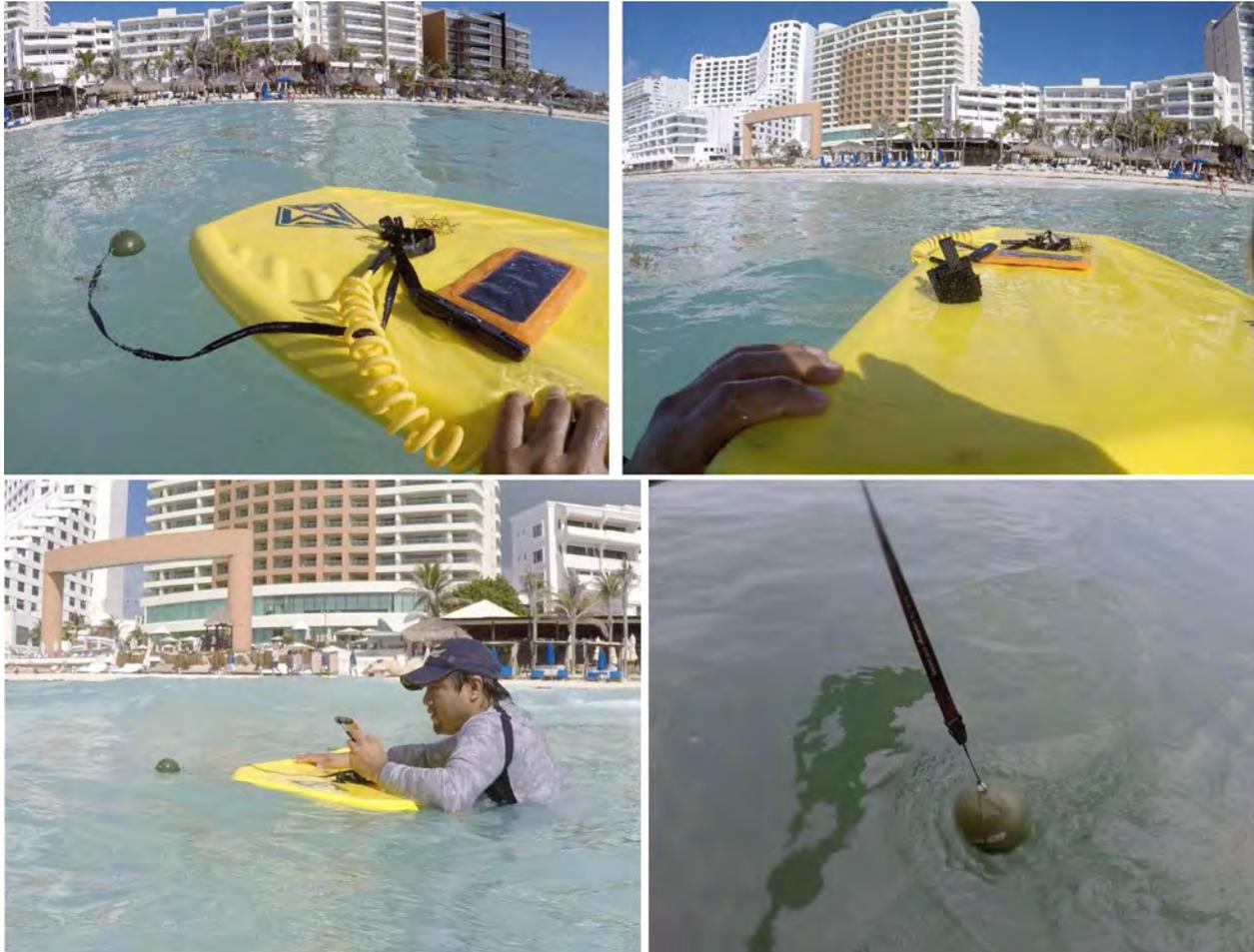
Figura 22. Recorridos realizados en el trayecto de la batimetría con el sonar Deeper Smart CHIRP.
