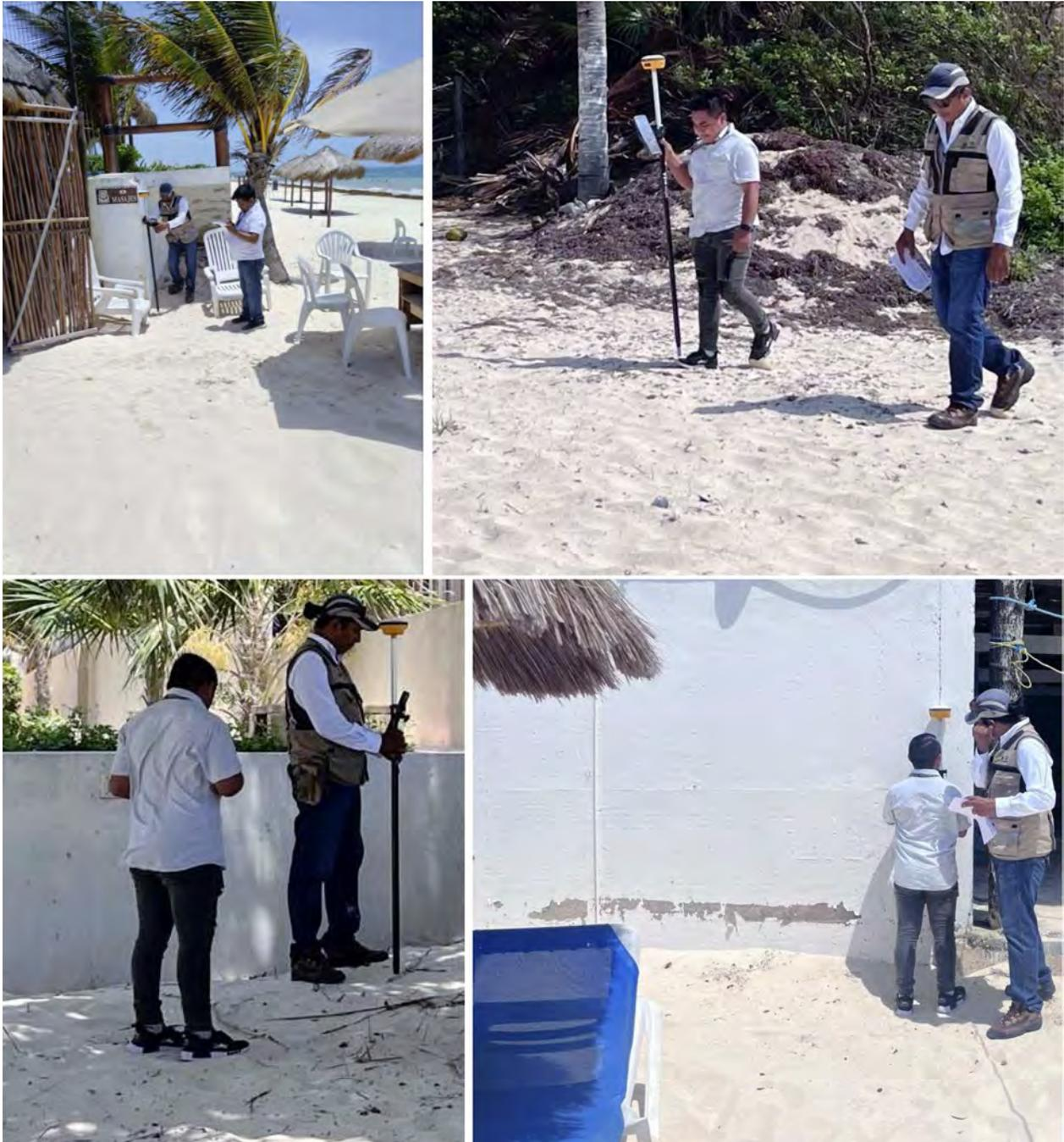
**Figura 32.** Uso en campo del equipo "GNSS RTK Hi-Target V200 con tecnología IMU".
