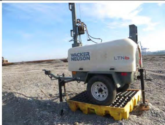
Protección de equipos contra fuga de hidrocarburos
