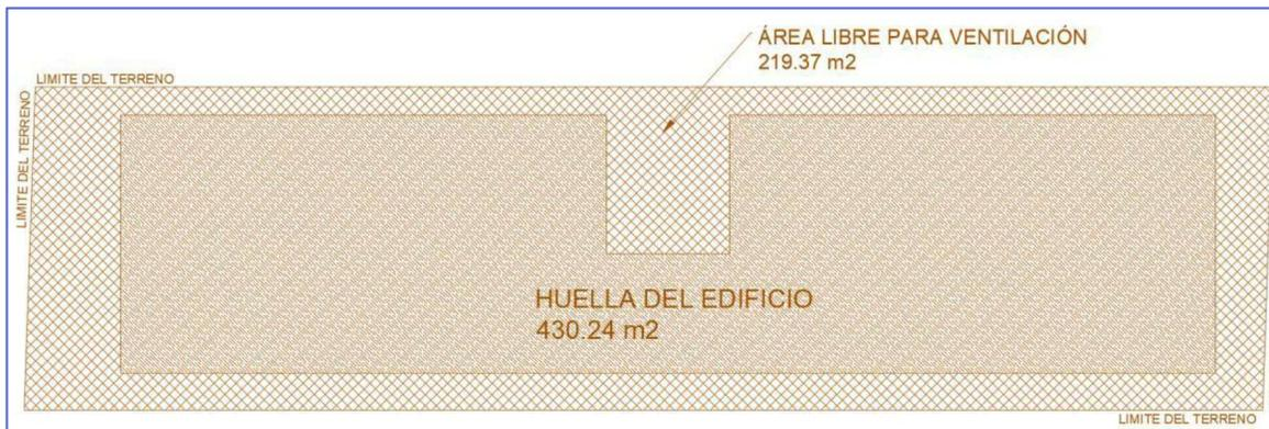
**Figura 5.** Desplante de la edificación, y área alrededor del edificio que permanecerá permeable.
