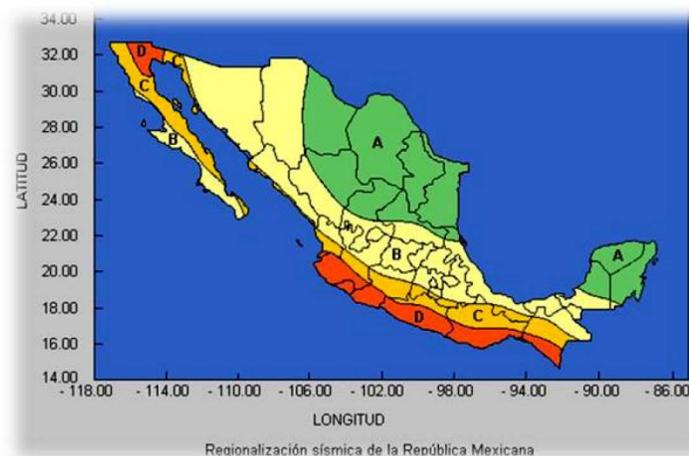
**Imagen 10.** Regionalización Sísmica de la República Mexicana. **A:** Bajo riesgo sísmico. **B:** Mediano riesgo sísmico. **C:** Alto riesgo sísmico. **D:**
