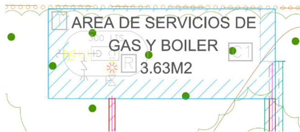
Figura 2.14. Imagen representativa del área de servicio de intaacion del gas LP y boiler.
