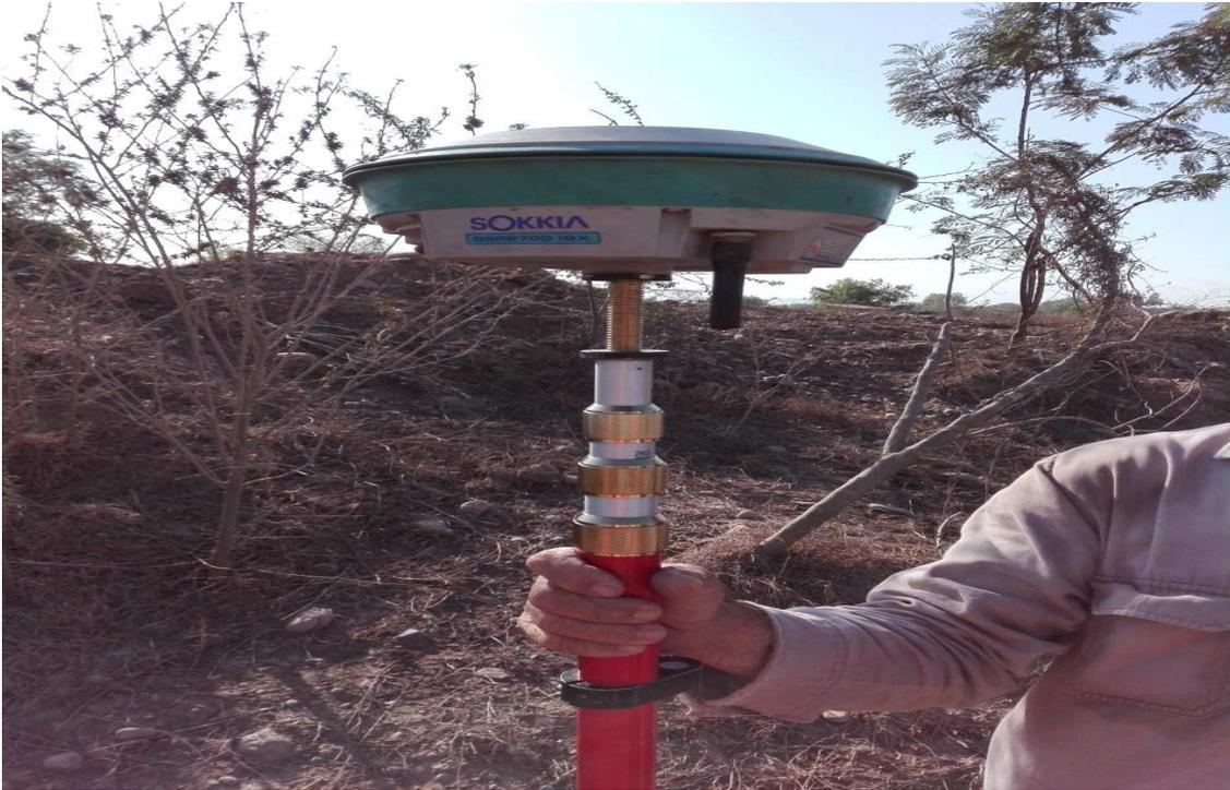
*Imagen 54. Instrumento utilizado en la topografía del proyecto.*
