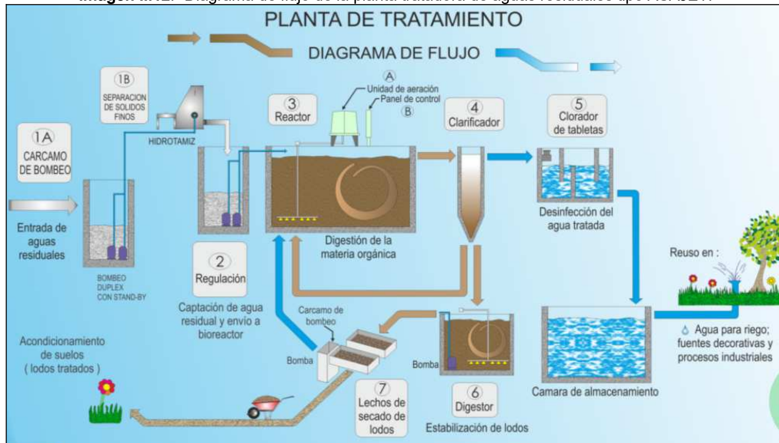
Imagen II.12.- Diagrama de flujo de la planta tratadora de aguas residuales tipo ASAJET.
