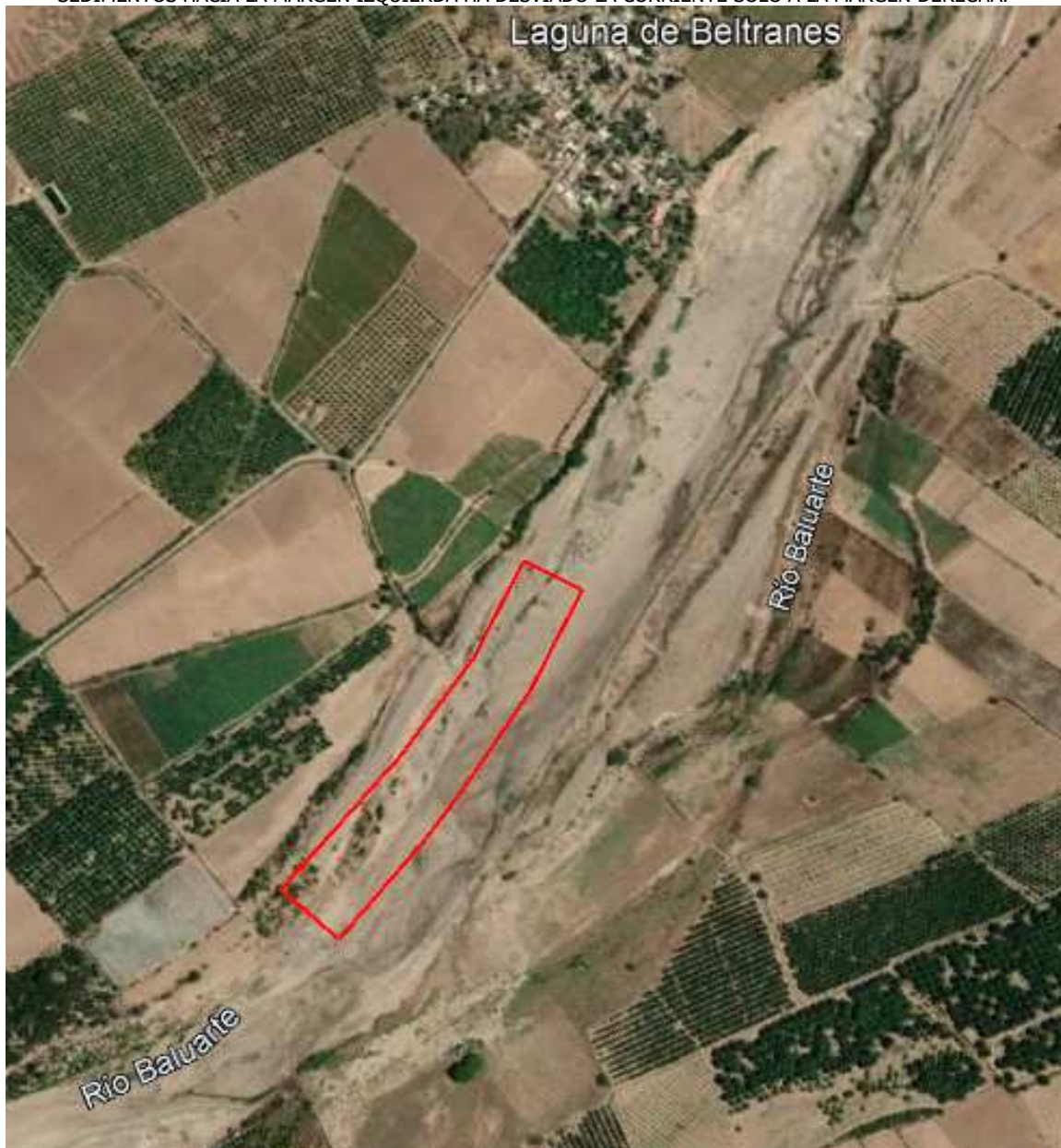
FIGURA 19. APRECIACIÓN DEL PROYECTO DENTRO DEL RIO BALUARTE. EL MEANDRO FORMADO POR ACARREO DE SEDIMENTOS HACIA LA MARGEN IZQUIERDA HA DESVIADO LA CORRIENTE SOLO A LA MARGEN DERECHA.
