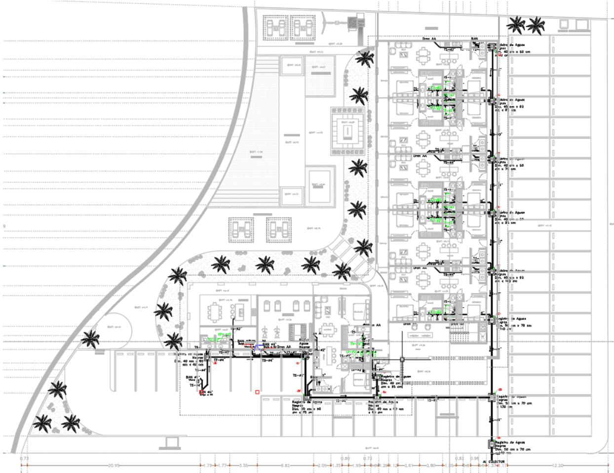
**Figura 12.** Plano descriptivo línea de conducción de descarga aguas residuales por diferencia de niveles a descargar a colector de red municipal.
