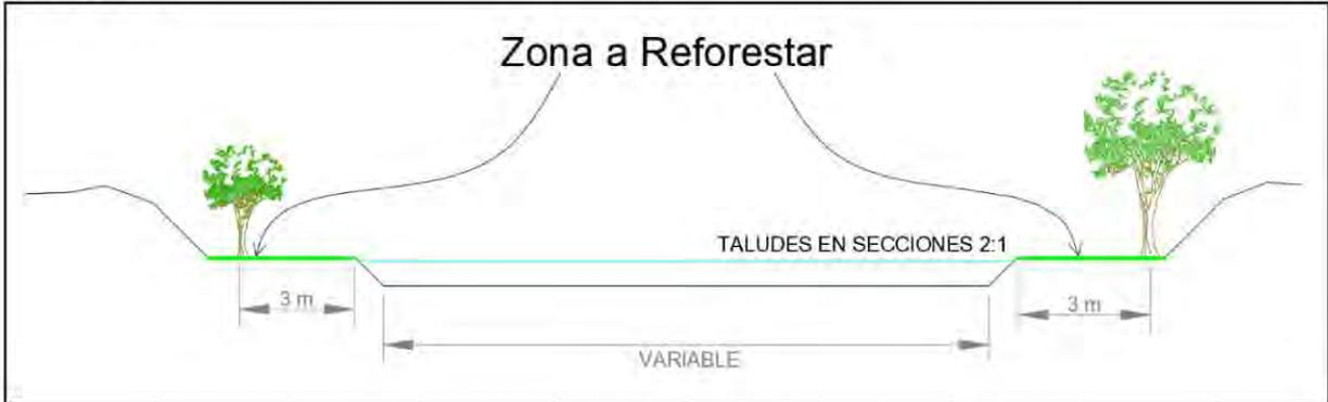
Imagen 10.- Sección tipo del cauce con el proyecto finalizado.
