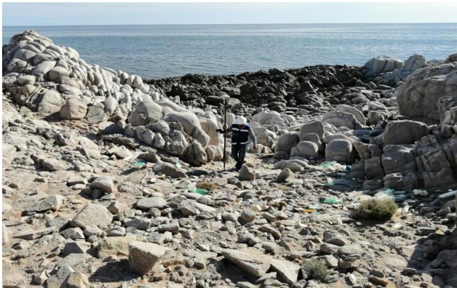
**Figura IV. 23 Personal topográfico realizando perfiles playeros con equipo GPS R8, marca trimble en sitio de estudio.**
