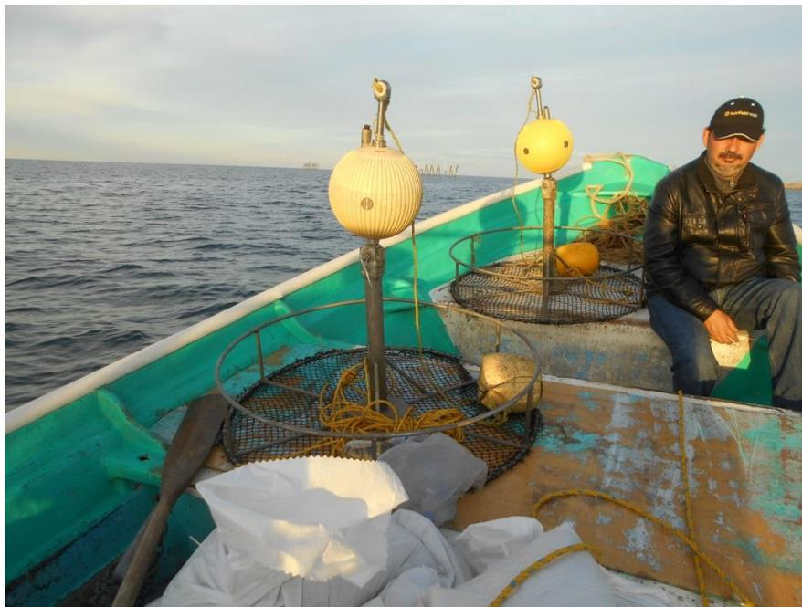
**Figura IV. 25 Correntómetros electromagnéticos marca INTEROCEAN modelo S4 y S4DW, los cuales se utilizarán para campaña de medición oceanográfica en sitio de estudio. Se muestra la canastilla de aluminio utilizada como anclaje.**
