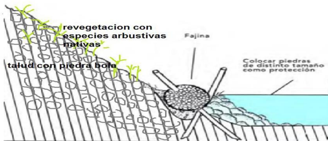
Ilustración 13. Talud protegido con piedra bola acomodada y revegetación
