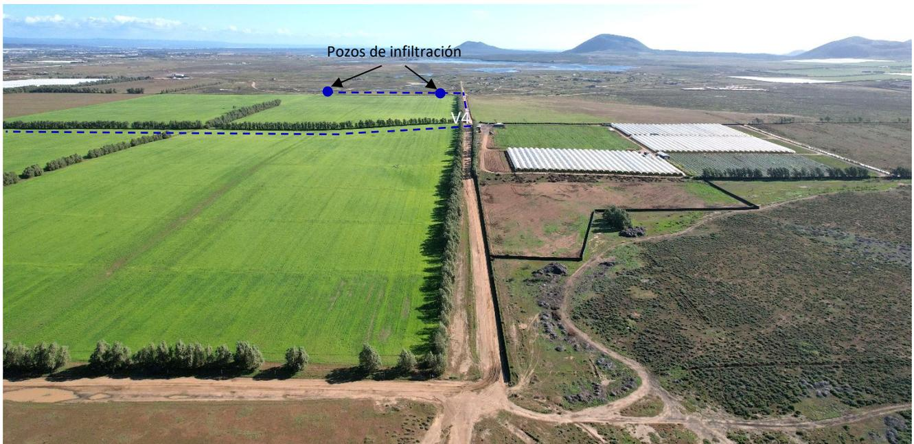
**Foto 14.** Fotografía aérea que muestra la línea de la tubería del agua de rechazo (color azul) del vértice 4 a los dos pozos de infiltración (círculo azul; fotografía tomada en febrero de 2024 en época de lluvias). En la tabla 6 se presentan las coordenadas de los vértices de esta obra.
