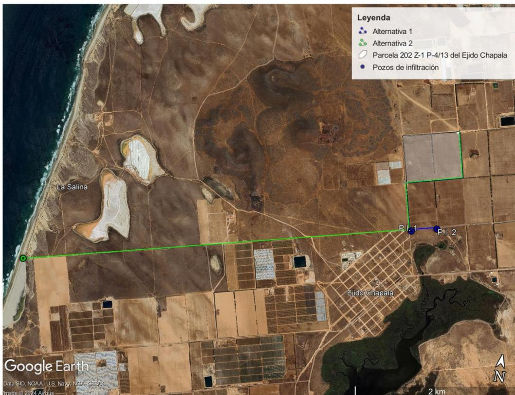
**Figura 4.** Imagen satelital donde se muestra las dos alternativas para descargar el agua de rechazo. La línea azul muestra la ruta para los pozos de infiltración en la parcela 81 Z-1 P-1/3 del Ejido Chapala y la línea verde para descarga en la línea de costa en la playa San Ramón.
