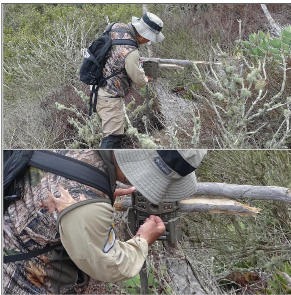
Figura 54. Programación y colocación de cámara-trampa.
