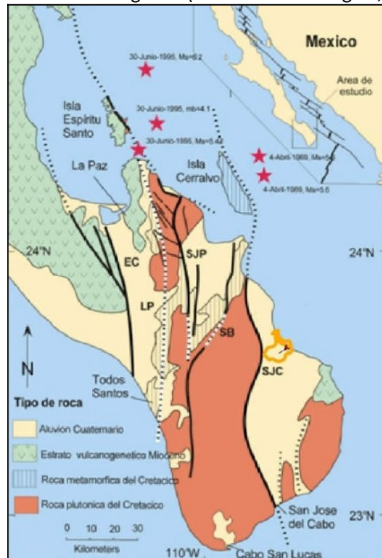
Figura 29. Mapa geológico de la región La Paz-Los Cabos y la distribución de las principales estructuras (fallas): EC, Falla El Carrizal; LP, Lineamiento La Paz; SJP, San Juan de Los Planes; SB, Falla San Bartolo; SJC, Falla San José del Cabo. Se muestra los epicentros de los temblores más fuertes ocurridos en la región. La fuente de información para la figura incluye Molnar (1973), Munguía et al., (1992,1997) y Fletcher and Munguía (2000).
