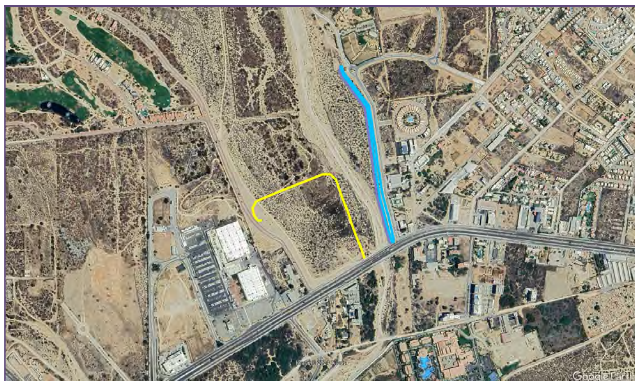
Figura 12.- Imagen de Google Earth donde se han sobrepuesto las obras asociadas al proyecto Construcción del Centro Comercial Galerías Los Cabos. La línea amarilla es la fracción del muro perimetral a utilizar como muro de contención (margen derecha) y la línea en azul, es el muro de contención en la margen izquierda del arroyo El Salto.
