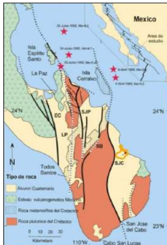
Figura 31. Mapa geológico de la región La Paz-Los Cabos y la distribución de las principales estructuras (fallas): EC, Falla El Carrizal; LP, Lineamiento La Paz; SJP, San Juan de Los Planes; SB, Falla San Bartolo; SJC, Falla San José del Cabo. Se muestra los epicentros de los temblores más fuertes ocurridos en la región. La fuente de información para la figura incluye Molnar (1973), Munguía et al., (1992,1997) y Fletcher and Munguía (2000).
