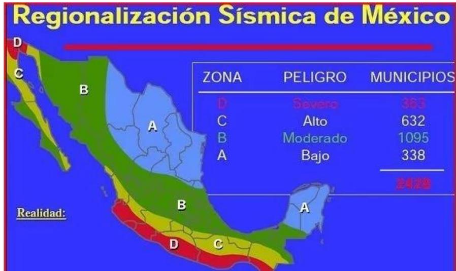
Figura 27. Regionalización sísmica del país, incluyendo la península de Baja California, realizada por la CFE. Sismicidad: a) zona A baja; b) zona B, media; c) zona C, alta y, d) zona D, muy alta.
