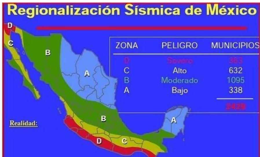
Figura 30. Regionalización sísmica del país, incluyendo la península de Baja California, realizada por la CFE. Sismicidad: a) zona A baja; b) zona B, media; c) zona C, alta y, d) zona D, muy alta.
