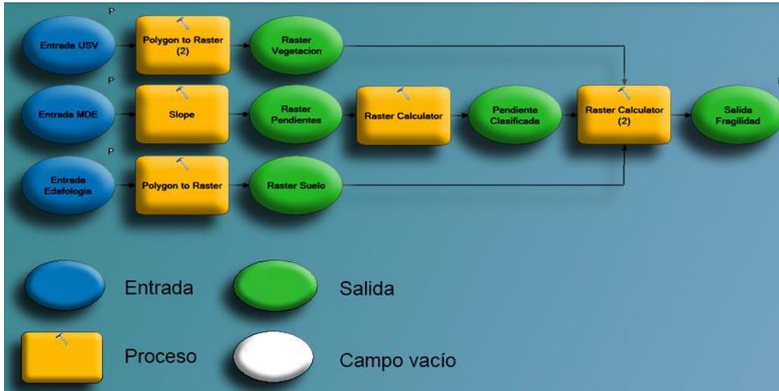
Figura 74. Diagrama de flujo utilizado en Model Builder para la obtención de fragilidad natural.
