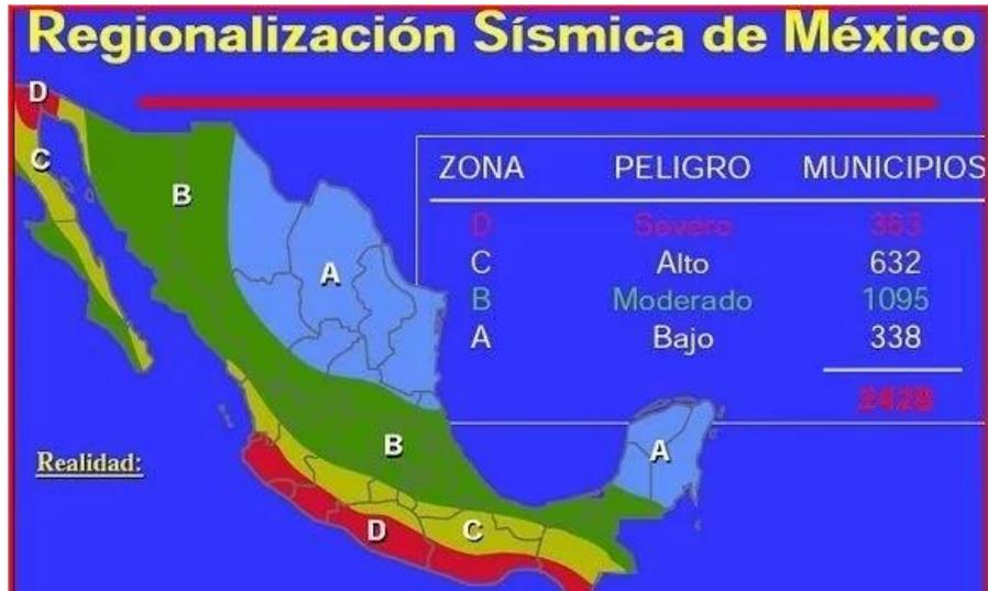
Figura 28. Regionalización sísmica del país, incluyendo la península de Baja California, realizada por la CFE. Sismicidad: a) zona A baja; b) zona B, media; c) zona C, alta y, d) zona D, muy alta.
