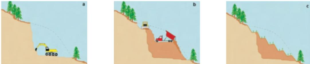
Figura Error: no se encontró el origen de la referencia-5. Proceso de suavización de un talud: a) condición original, b) acomodo de material de relleno y suelo vegetal, y c) realización de terrazas y establecimiento de cubierta vegetal (Fuente: Ruíz-Prieto, 2008).
