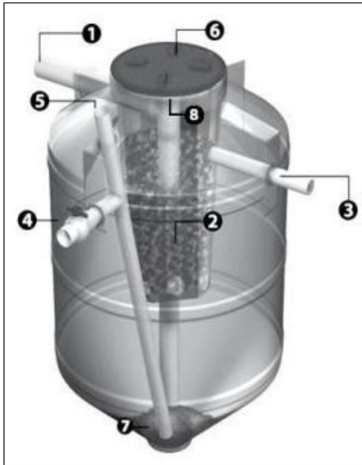
Ilustración II.2.5.3. Descripción de Biodigestor Autolimpiable.
