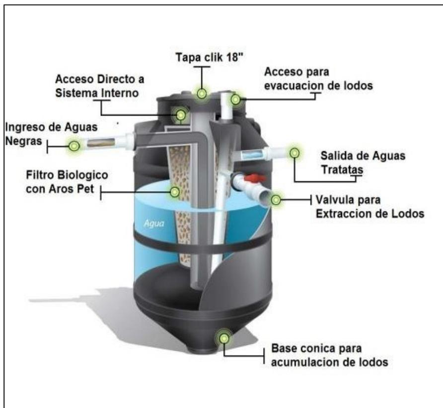
Ilustración II.2.5.4. Descripción de Biodigestor Autolimpiable.
