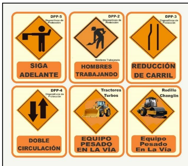
Figura II.2.11.1. Señalizaciones de hombres trabajando.
