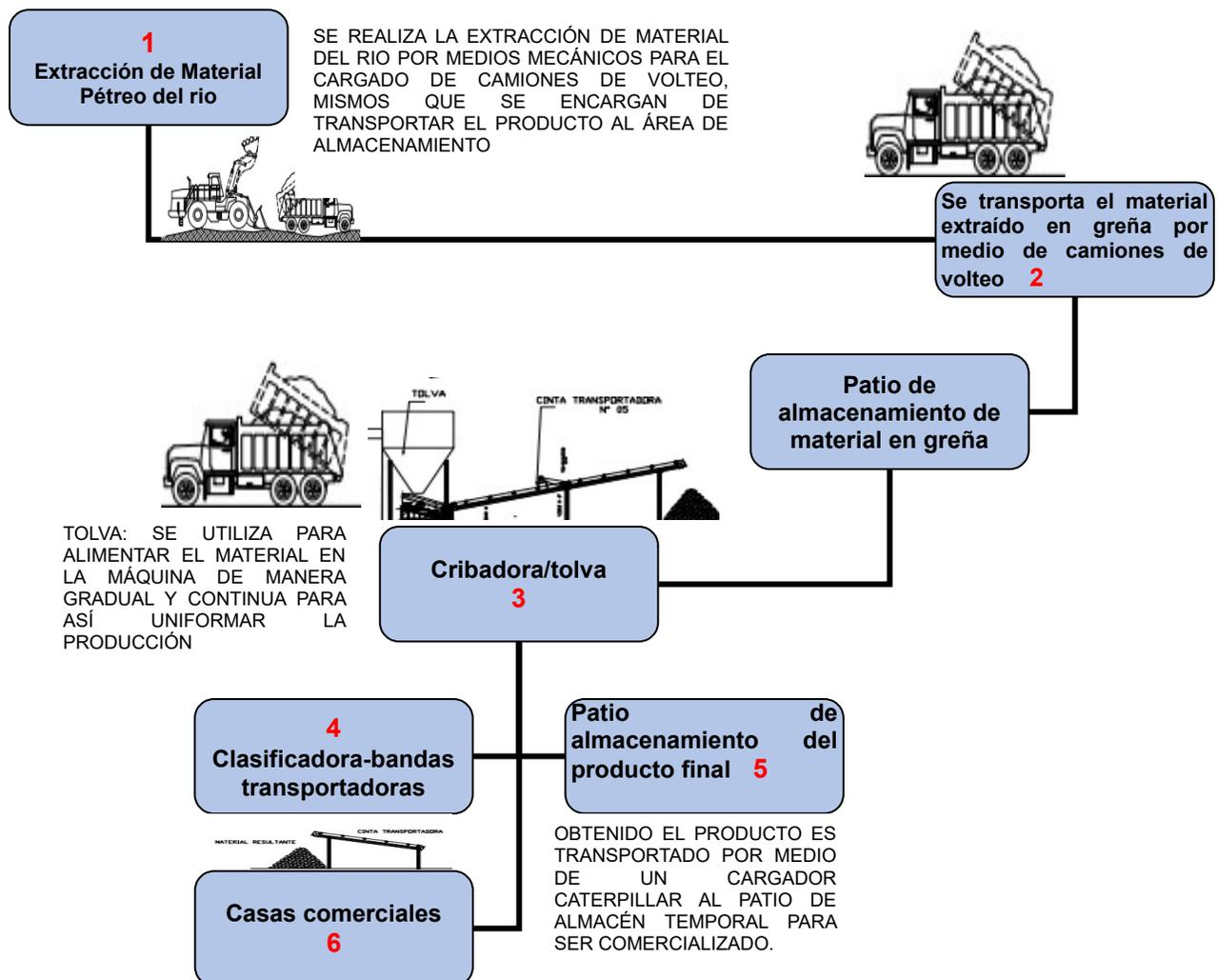
El área de extracción del material pétreo tiene una superficie de 14,000.00 m<sup>2</sup>, dando un volumen para explotar de 8,640.00 m<sup>3</sup> por año, y se tiene programado explotar el sitio por tres años dando un total de 25,920.00 m<sup>3</sup>.
