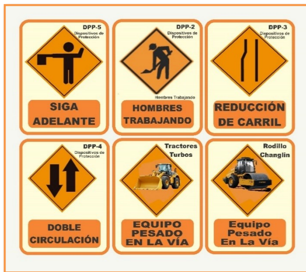
Ilustración II.2.11.1. Señalizaciones de hombres trabajando.
