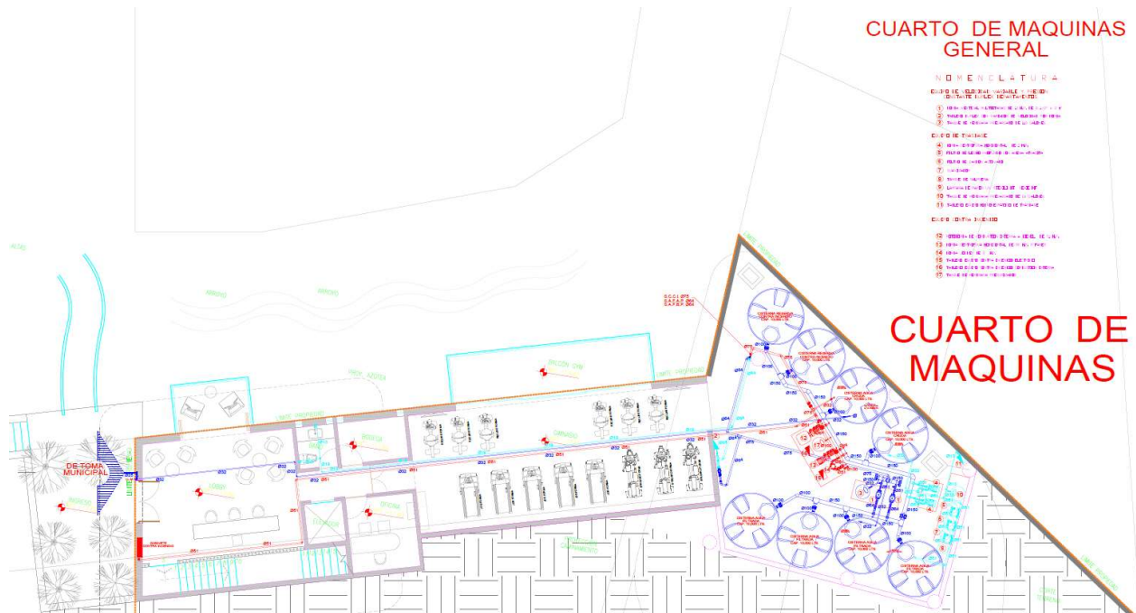
Figura 24. Instalación hidráulica, nivel de lobby
