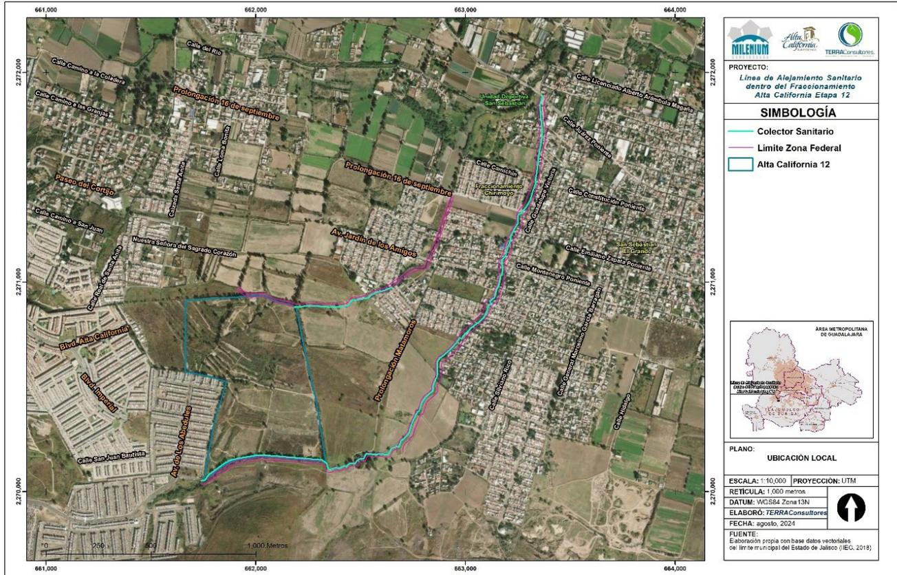
Figura 9 Ubicación del colector No.1 y No.2 de la línea de alejamiento.
