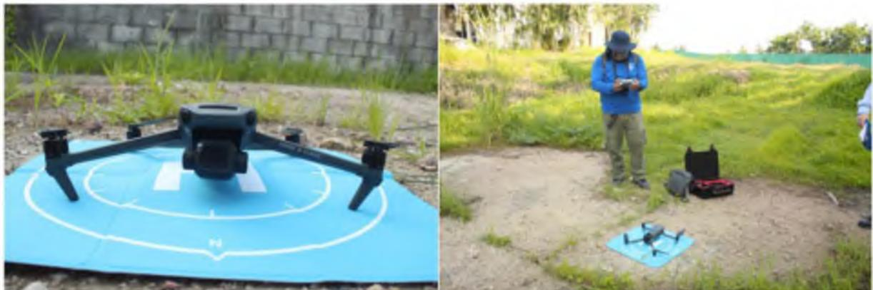
Imagen 54. Equipo utilizado en el levantamiento de información (DJI Mavic 3 Classic).
