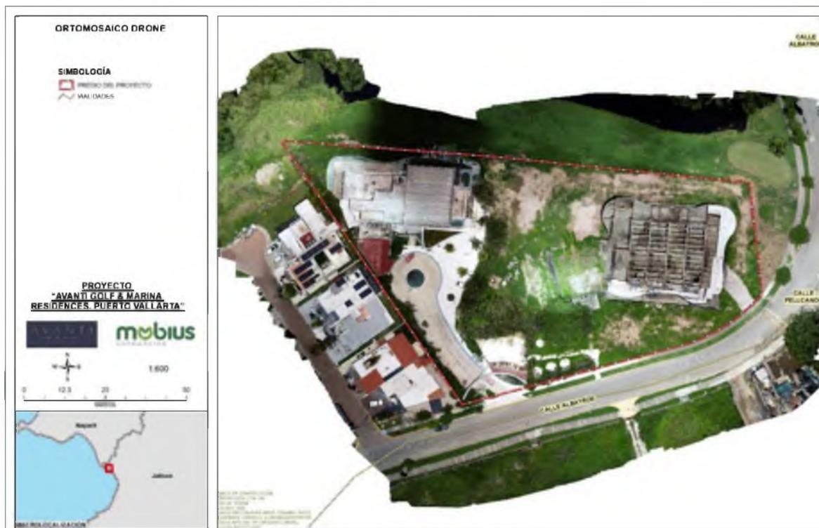
Imagen 58. Ortomosaico generado que se obtuvo con el levantamiento fotográfico aéreo y el procesamiento mediante un Sistema de Información Geográfica (SIG), en las áreas consideradas para el Proyecto.
