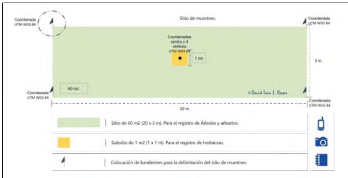
Imagen 60. Representación esquemática para el diseño de los sitios de muestreo rectangulares.
