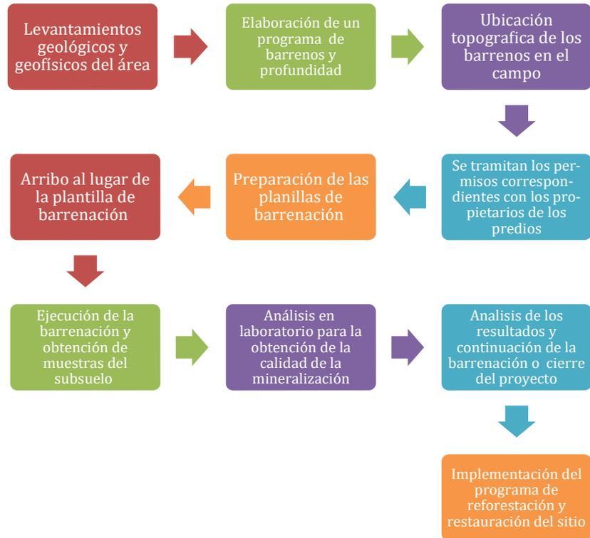
Fig. 11 Proceso de barrenación de diamante.
