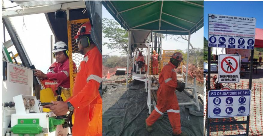
Fotografía 6. Equipo de protección del personal en la zona de barrenación (Nota: la imagen no corresponde a alguno de los puntos que se encuentran en evaluación)
