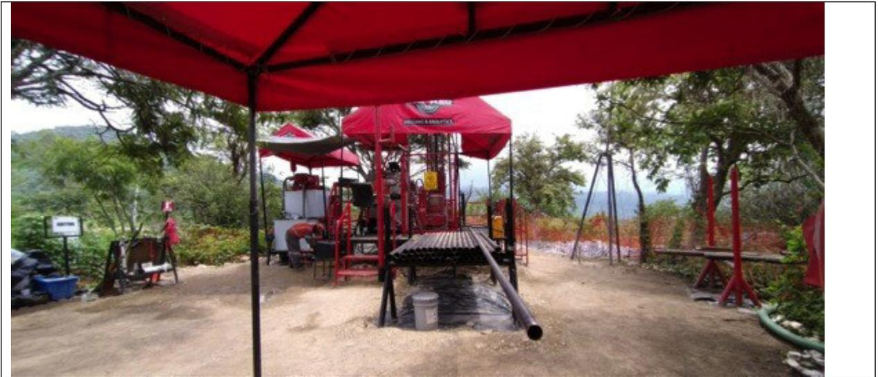
*Fotografía 13. Equipo de preparación de lodos (izquierda), al centro máquina de perforación.*
