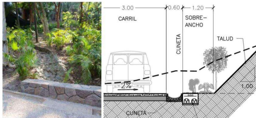
Ejemplo de cuneta para captación pluvial superficial.
